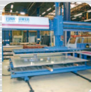
Poinçonneuse / Cisaille
