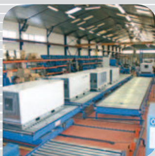
Ligne d'assemblage semi-DFT
