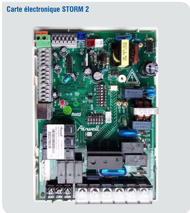
La configuration de la carte électronique **STORM 2** permet **quatre différents modes de fonctionnement** des pompes à chaleur sur boucle d'eau par sélection des systèmes suivants :
