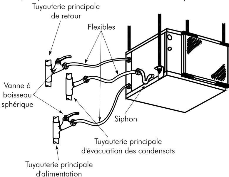
4. Certains raccords filetés de tuyaux flexibles sont fournis avec une pâte à joint. Dans le cas contraire, utiliser du ruban Teflon pour assurer un joint étanche.
