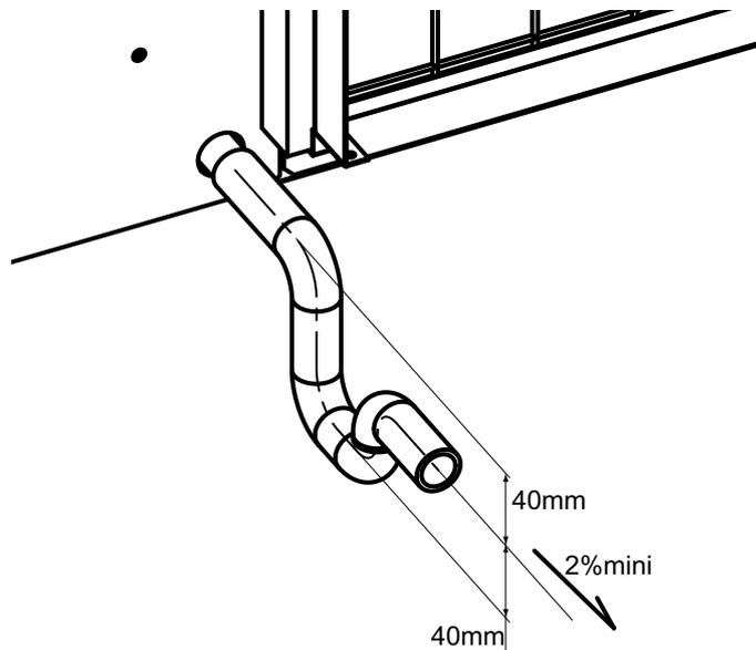
Un système complet d'évacuation des condensats en cuivre ou en P.V.C. peut également être utilisé.
