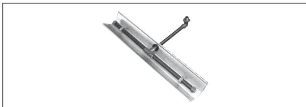
Pour le démontage, déclipser la rampe et la dégager en la faisant pivoter.
