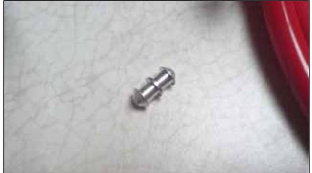
1) Mettre la pièce de jonction dans la courroie à l'aide d'une pince.
