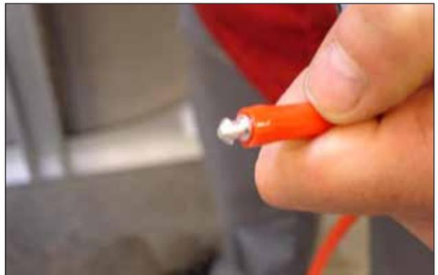
2) Utiliser de l'adhésif pour fixer la courroie sur le récupérateur rotatif et effectuer une rotation complète de ce dernier. N.B. la courroie doit être montée de façon à ne pas interférer avec la carrosserie ainsi que les différentes parties du récupérateur comme montré sur le dessin de droite.
