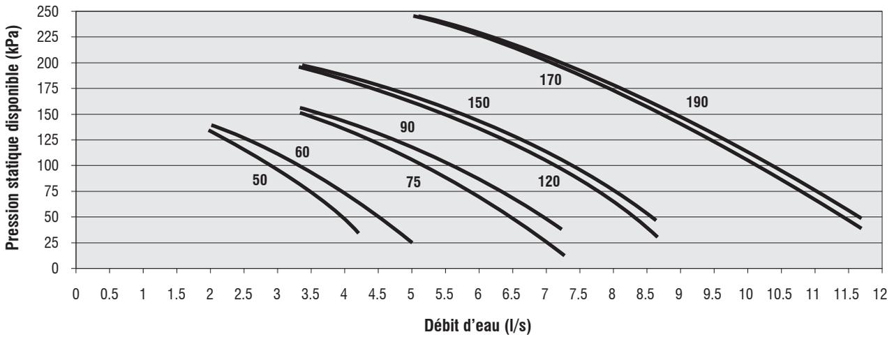
WQL/H 50-190 Courbes des pompes hydrauliques - Échangeur thermique externe (1/2P SP/C)
