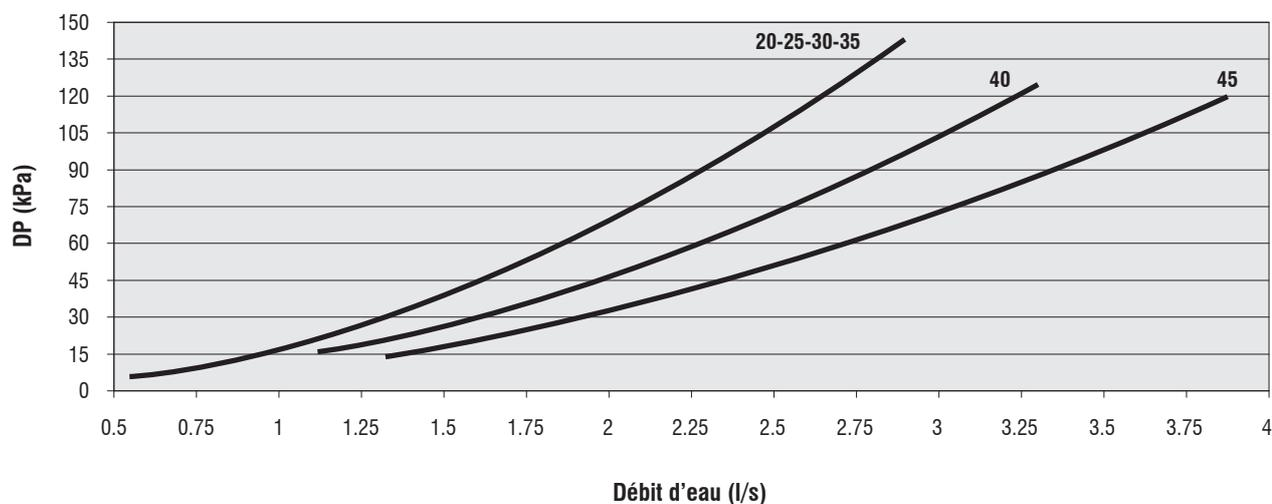
**WQL/H 20/45 - Courbes de pertes de charge - Échangeur thermique externe**
