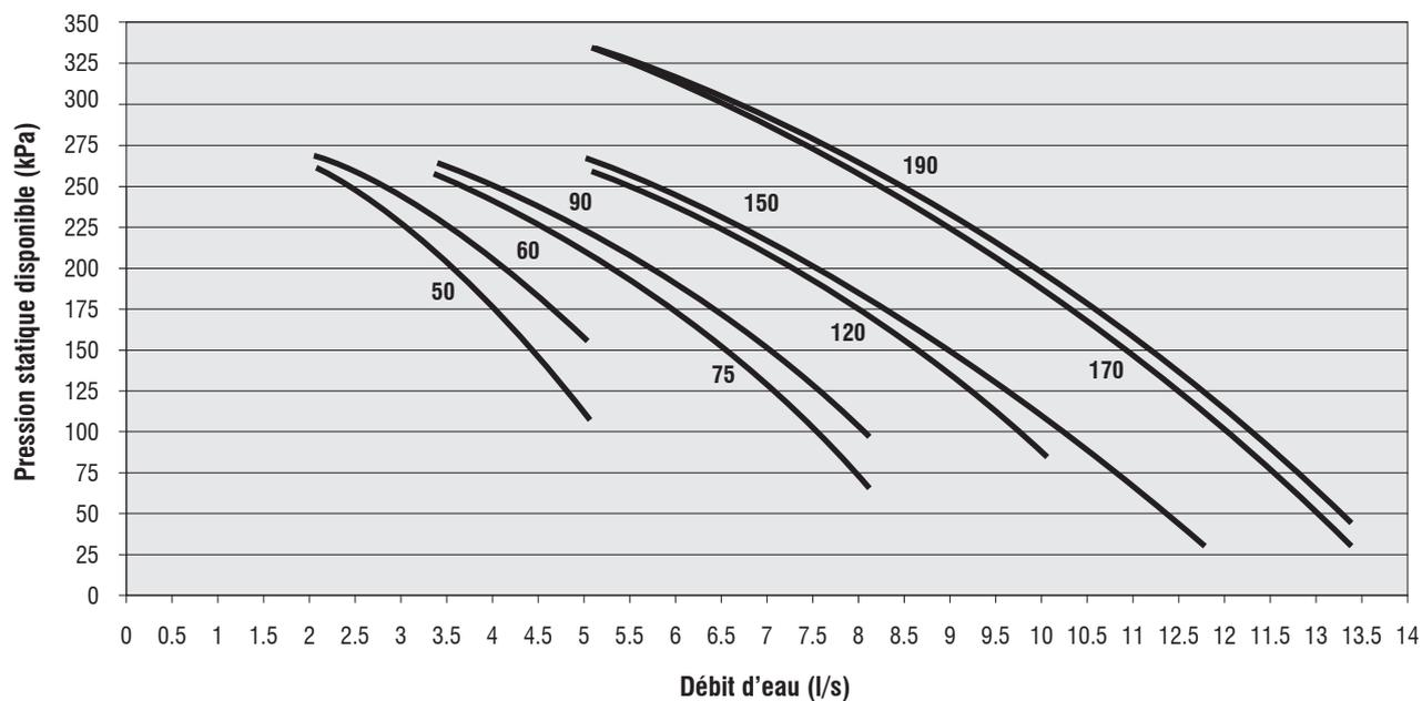
WQL/H 50-190 Courbes des pompes hydrauliques - Échangeur thermique externe (1/2P HP/C)
