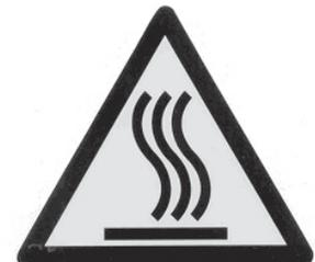
Avertissement zones à haute température A côté des conduites ou des composants chauds
