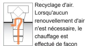
Le chauffage et la récupération de chaleur sont gérés suivant les besoins calorifiques.
